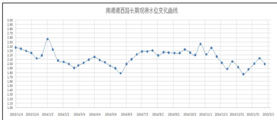
图 5.1-10 南港港西路周围长期潜水水位监测曲线 (2013.11~2015.3)
