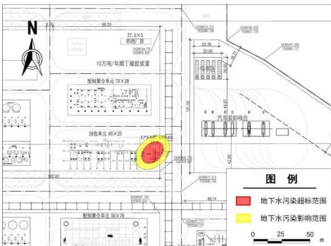
图 6.2-13 顺丁橡胶装置污水池裂缝泄漏后镍 1000 天污染晕运移分布范围图
