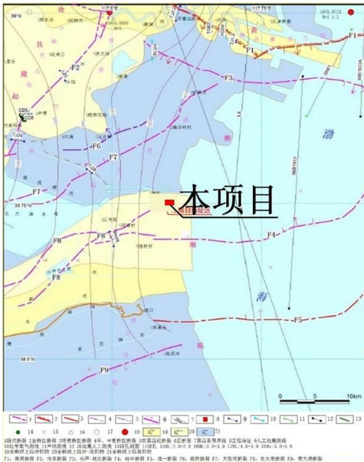
图 5.1-6 拟建场地区域断裂构造图
